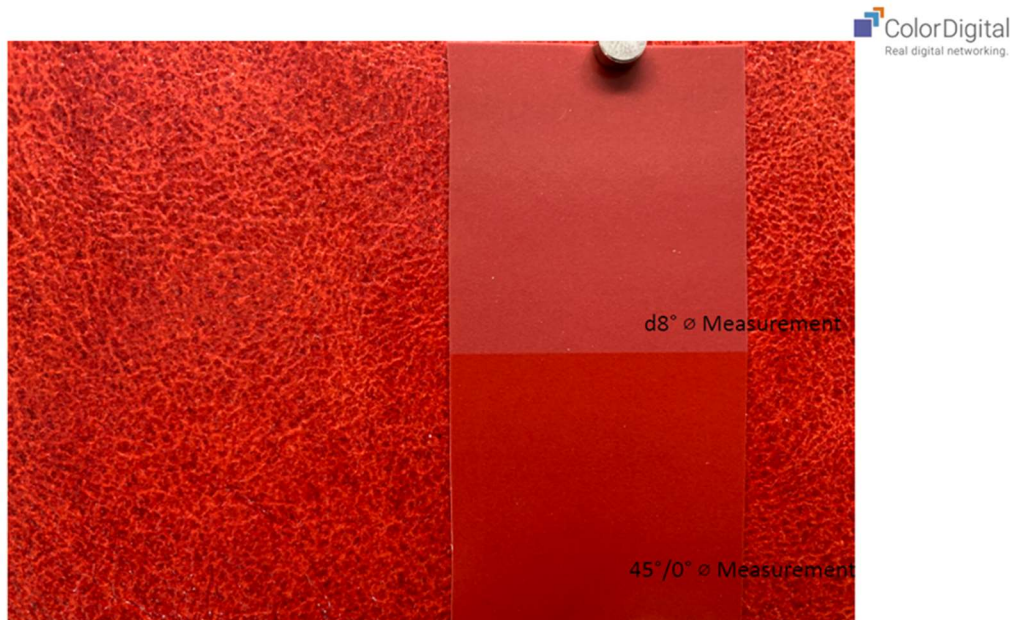
Bild 9: Beispiel für einen visuellen Unterschied zwischen 8^\circ diffuser Farbmessung und 45^\circ / 0^\circ Messprinzip, Color Digital GmbH, Köln 2020
